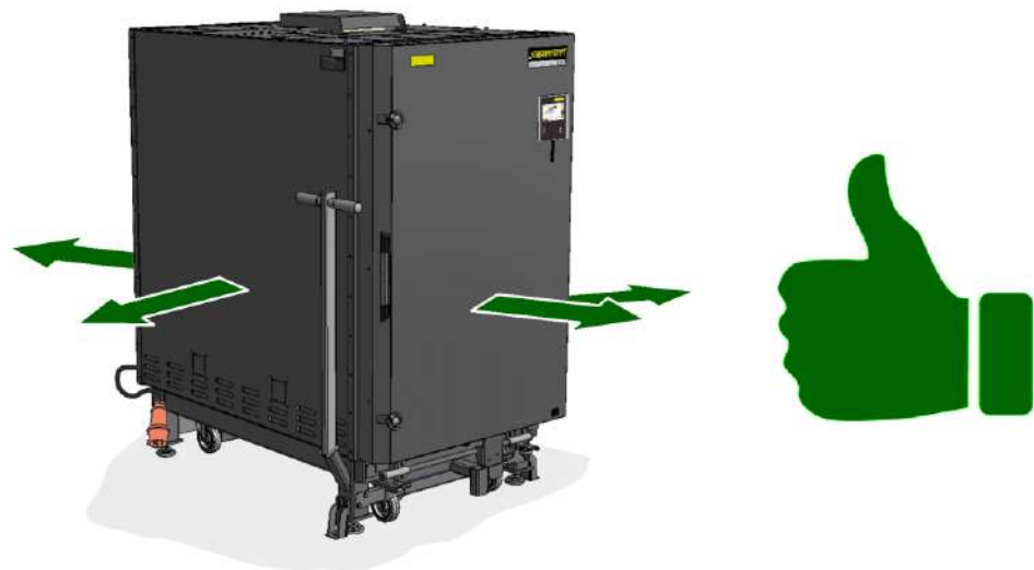
Fig. 38: Așezarea și poziționarea cuptorului (similar cu figura)
