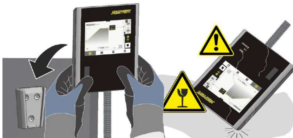
Fig. 71: Introduceți controllerul în suportul aflat pe cuptor (ca în imagine)
