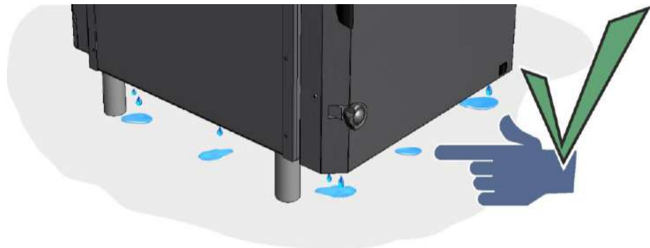
Fig. 67: Acumulări de condens în timpul primelor arderi (figură similară)
