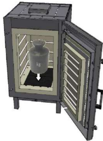
Fig. 74: Recomandare: Sarcina maximă pe podeaua cuptorului
