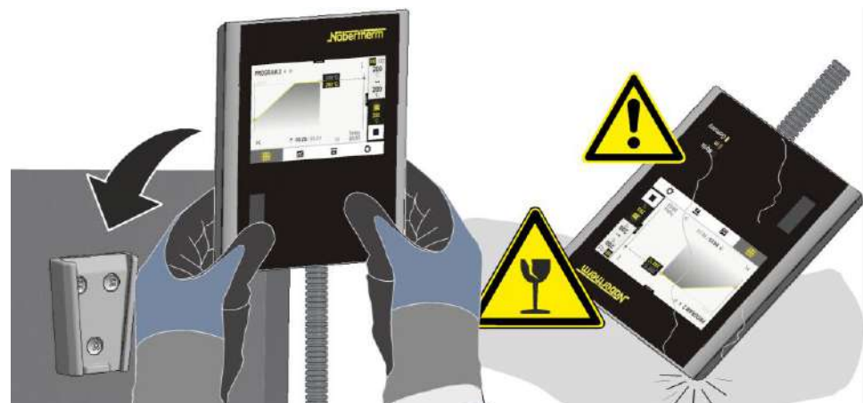
Fig. 55: Introduceți controllerul în suportul aflat pe cuptor (ca în imagine)
